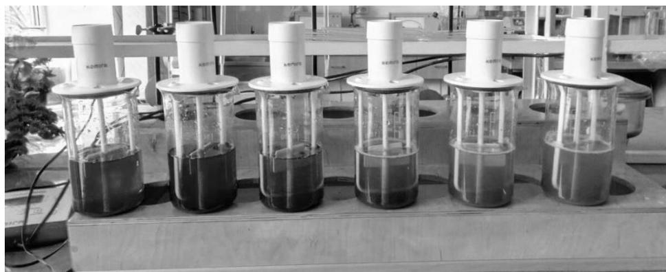
*Рис. 1 – Експериментальна установка для пробної коагуляції методом JAR-Test*
