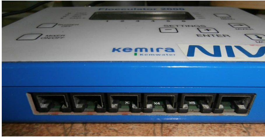
Рисунок 2.1 – LAN-порти апарату Flocculator 2000.
