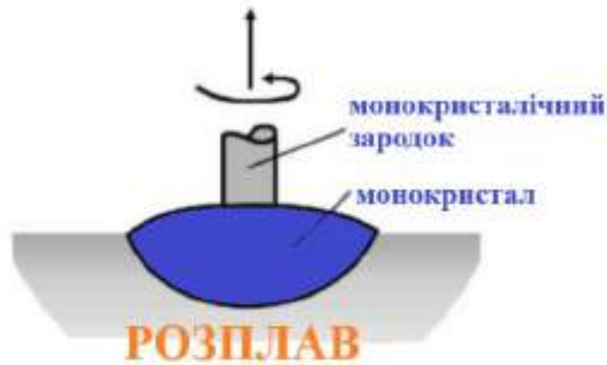
Рис. 4.3. Витягування монокристалів методом Кирпоулоуса [9]
