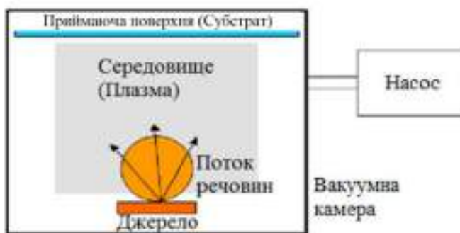
Рис. 2.3. Отримання неорганічних матеріалів PVD-методом електродуговим розрядом в плазмі [1]
