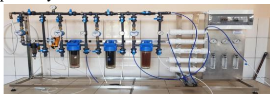
Рис 1. Фото зворотноосмотичної установки.
