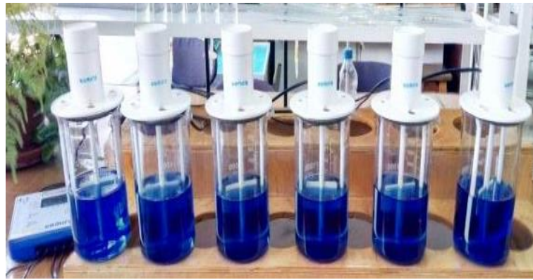
Рис. 1 – Експериментальна установка пробної коагуляції JAR-Test Flocculator 2000 Kemira
