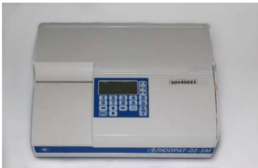
Аналізатор рідини «ФЛЮРАТ-02-5М»
