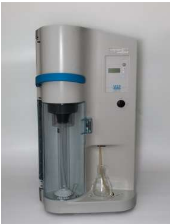
Дистиляційна установка за Кьельдалем Velp UDR 129
