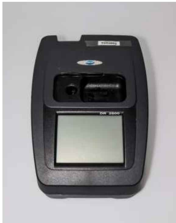
Спектрофотометр HACH Lange DR 2800
